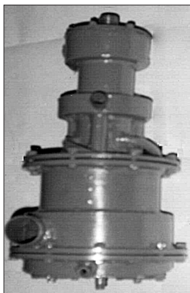
Рис. 1. Гідроциклон з модифікованою насадкою (загальний вигляд)
