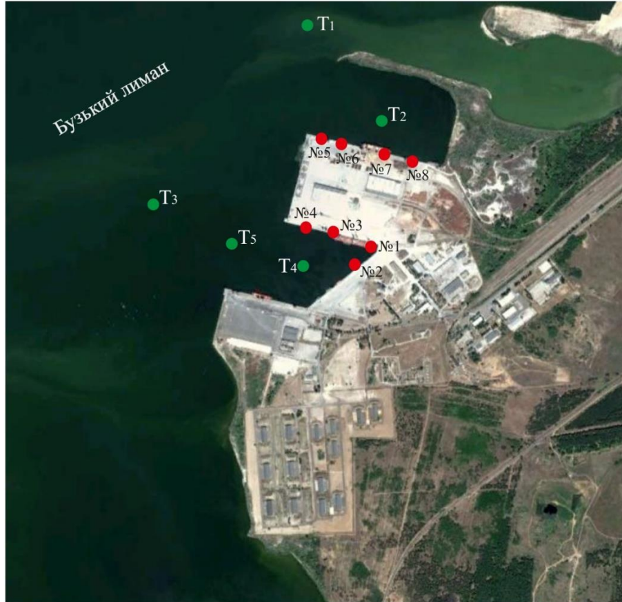
Карта розташування випусків стічних (зливови) вод та контрольних точок акваторії ДП «Стивідорна компанія «Ольвія»
