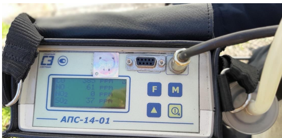
Рис. 2.14 – Дані вимірів забруднюючих речовин від котла
