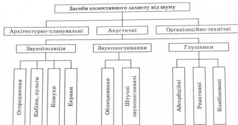
Рисунок 7.1. Засоби колективного захисту від шуму на шляху його поширення
