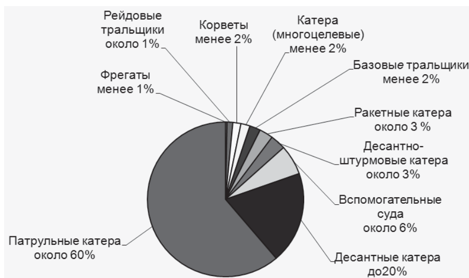
Рис. 1. Применение водометных движителей на кораблях, судах, катерах ВМС и Береговой Охраны различных стран в зависимости от класса, %
