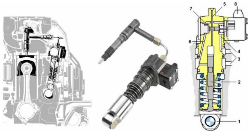
Рисунок 2.4 – Компонування, зовнішній вигляд і розріз індивідуального ПНВТ фірми R.Bosch для дизелів вантажних автомобілів з швидкодіючим електромагнітним клапаном зливу:
