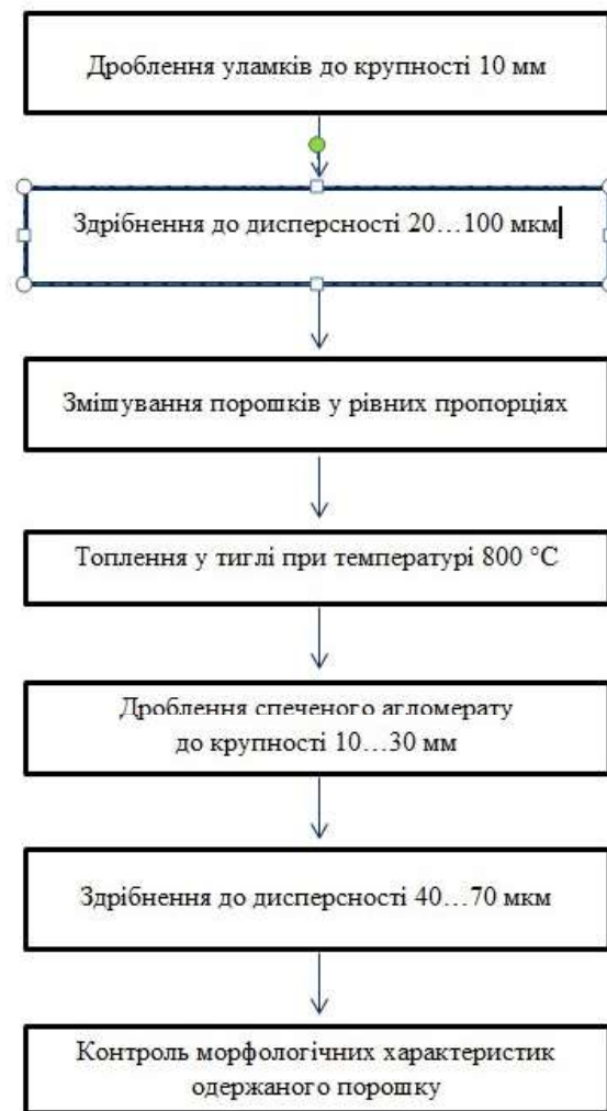
Рис. 1. Технологічна схема переробки бою скла та бракованих кришталевих виробів на стеклопорошок
