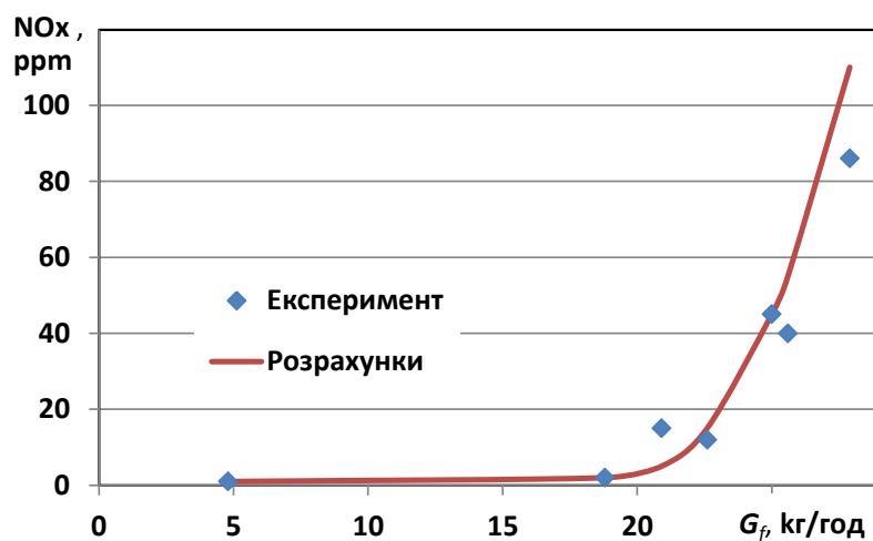
Рисунок 3.3 – Розподіл об’ємних концентрацій оксидів азоту на виході з камери згоряння в залежності від витрати палива:
