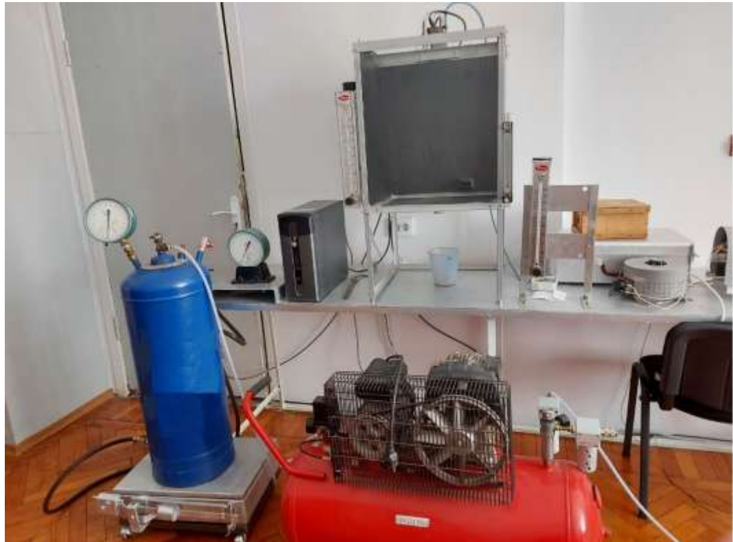
Рисунок 2.3 – Експериментальна установка для дослідження вольт-амперних і енергетичних характеристик генераторів повітряної плазми
