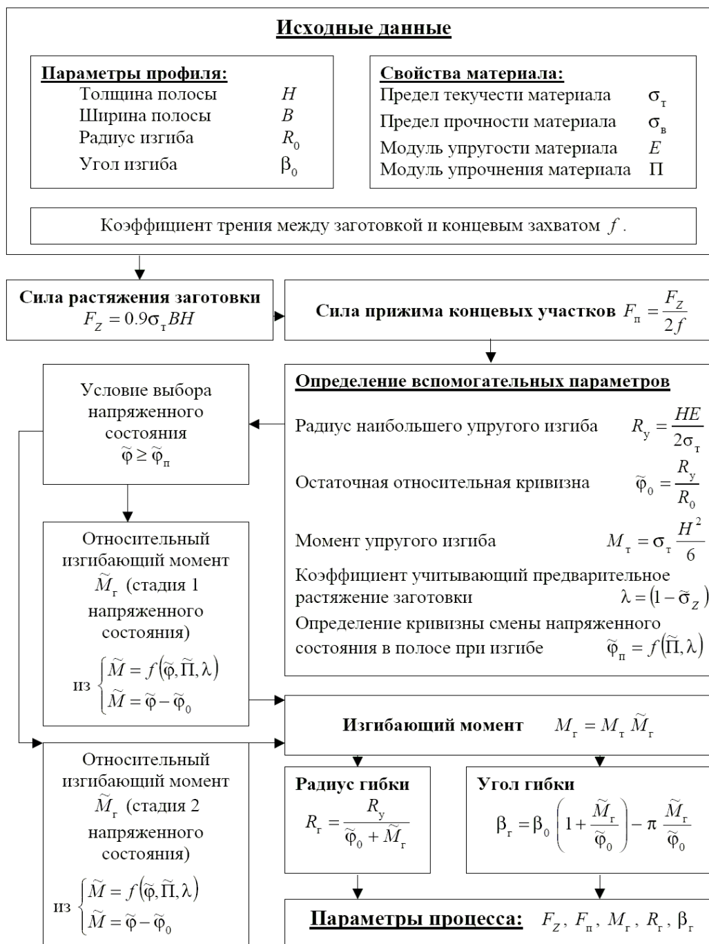
Рис. 4.5. Алгоритм расчета параметров технологического процесса изготовления профилей гибкой с продольным растяжением
