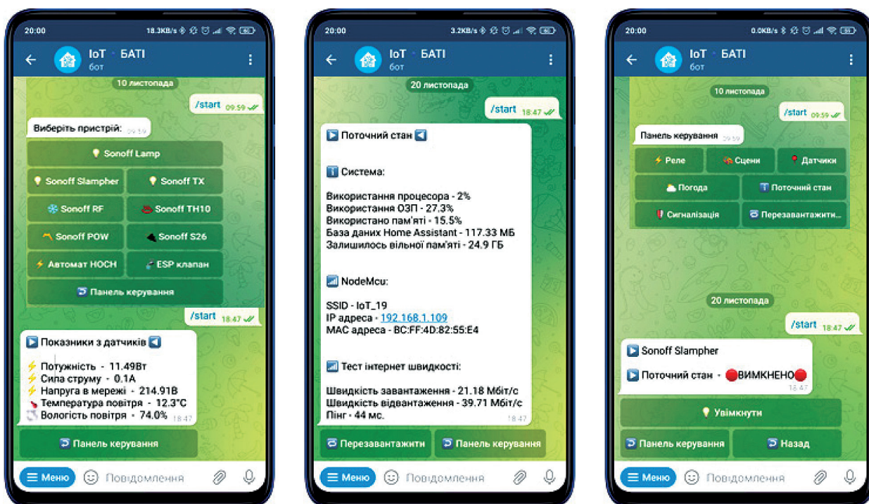
Рис. 2. Керування електричними пристроями через Telegram-бот
