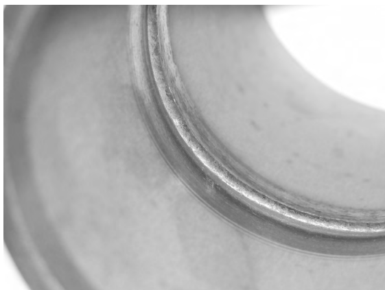
Рис. 5. Формирование обратной стороны шва при орбитальной АТІG-сварке
