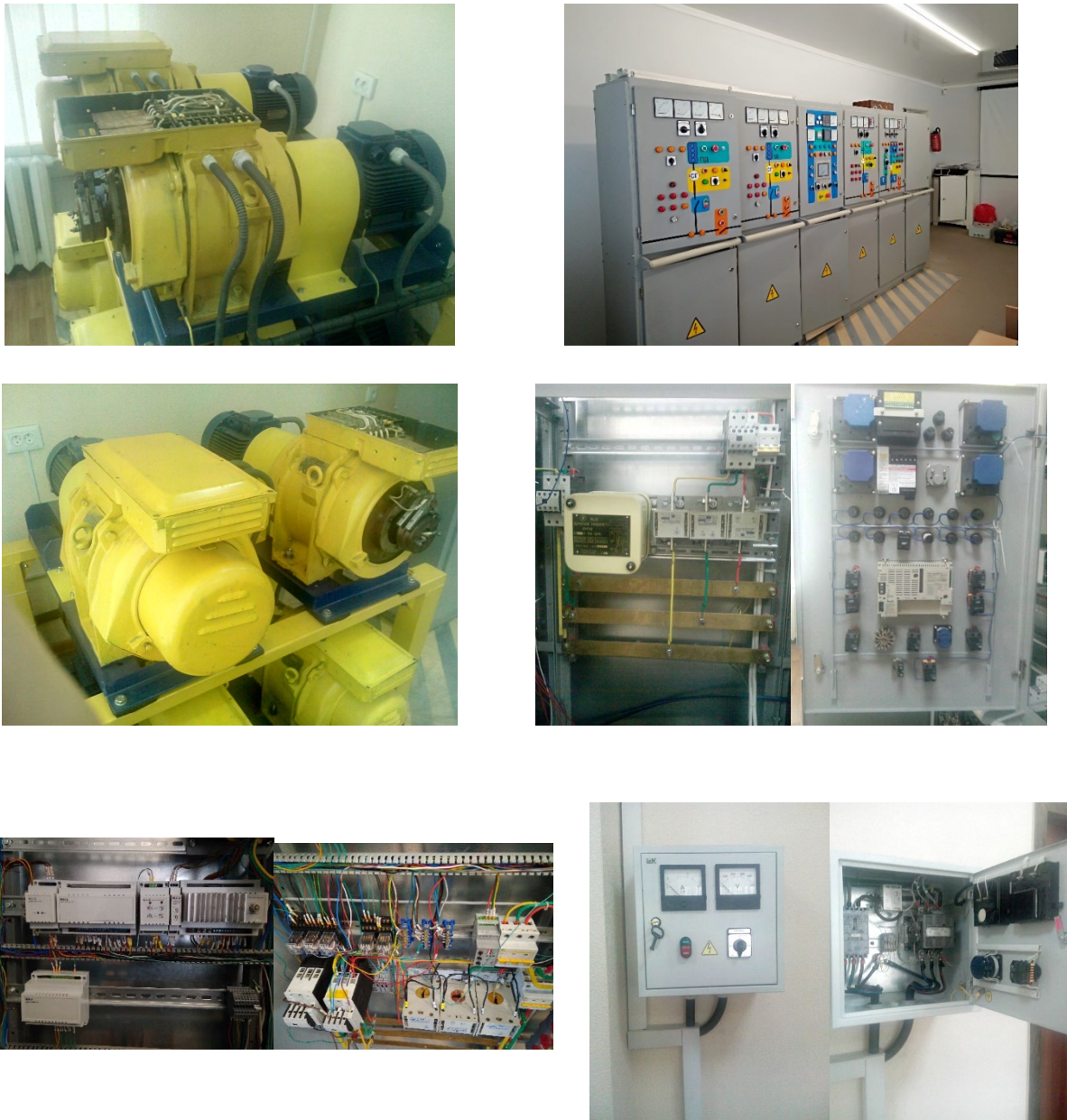
Рис. 3 – Апаратна модель суднової електростанції на черговому етапі монтажу
