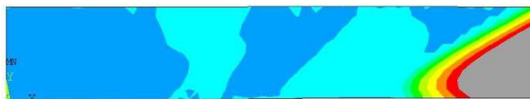
Рисунок 3.22 – Поля розподілу головних \sigma_l напружень в момент часу після закінчення нагрівання при використанні ацетиленово-кисневого ( a ) полум'я малоамперної аргонової дуги ( б ) й мікроплазмової дуги ( в )
