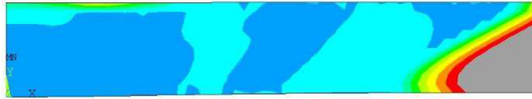
Рисунок 3.25 – Поля розподілу головних \sigma_I напружень в момент часу при охолодженні до T_{max}=1125^{\circ}\text{C} при використанні ацетиленово-кисневого ( a ) полум'я малоамперної аргонової дуги ( б ) й мікроплазмової дуги ( в )
