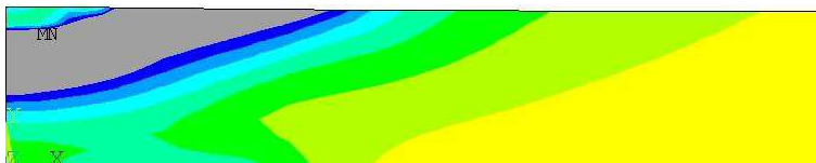
Рисунок 3.2 – Поля розподілу радіальних напружень \sigma_x в момент часу після закінчення нагрівання при використанні ацетиленово-кисневого ( a ) полум'я малоамперної аргонової дуги ( б ) й мікроплазмової дуги ( в )
