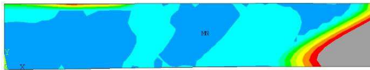
Рисунок 3.26 – Поля розподілу головних \sigma_I напружень в момент часу при охолодженні до T_{max}=1110^{\circ}\text{C} при використанні ацетиленово-кисневого ( a ) полум'я малоамперної аргонової дуги ( б ) й мікроплазмової дуги ( в )
