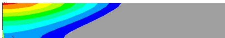
Рисунок 2.9 – Поля розподілу температур в моменти часу після закінчення нагрівання до T_{max}=1125^{\circ}C при використанні a – ацетиленово-кисневого полум'я; б – малоамперної аргонової дуги в – мікроплазмової дуги
