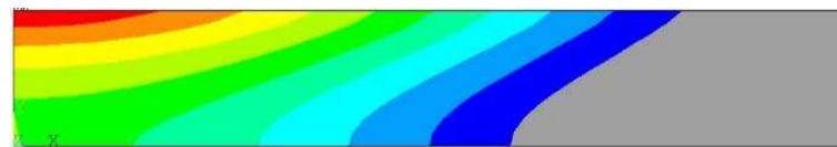
Рисунок 2.7 – Поля розподілу температур в моменти часу після закінчення нагрівання до T_{max}=1175^{\circ}\text{C} при використанні a – ацетиленово-кисневого полум'я; б – малоамперної аргонної дуги в – мікроплазмової дуги
