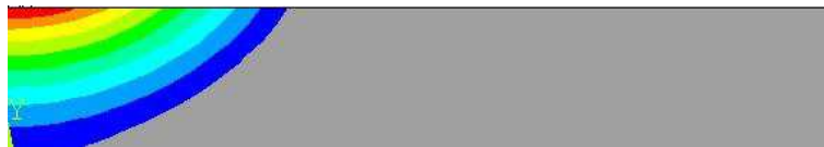
Рисунок 2.6 – Поля розподілу температур в моменти часу після закінчення нагрівання до T_{max}=1200^{\circ}\text{C} при використанні: a – ацетиленово-кисневого полум'я; б – малоамперної аргонної дуги в – мікроплазмової дуги
