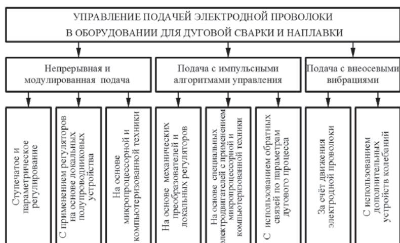
Рис. 1. Основные направления разработок механизма подачи электродной проволоки для механизированного оборудования (без учета приводов с электромагнитными регуляторами)
