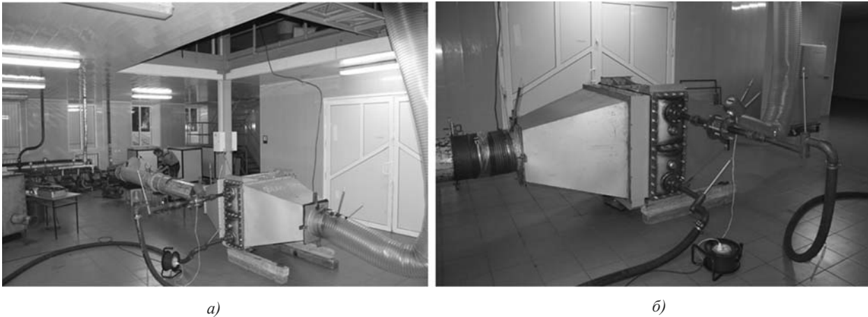
Рис. 5. Общий вид экспериментальной установки (а) и бустерного водяного охладителя воздуха типа ОВВМ (б)
