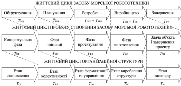
Рис. 1. Схема життєвого циклу організаційної структури у контексті життєвого циклу ЗМР та життєвого циклу проекту
