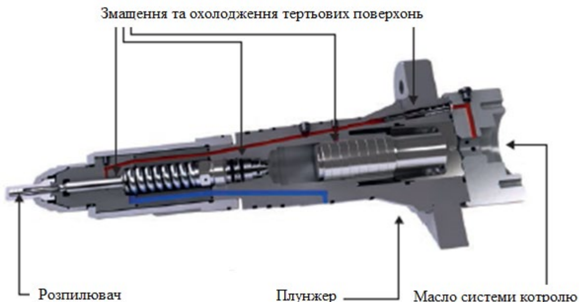
Рисунок 3.4 – Перетин інжекційного клапана (FBIV)
